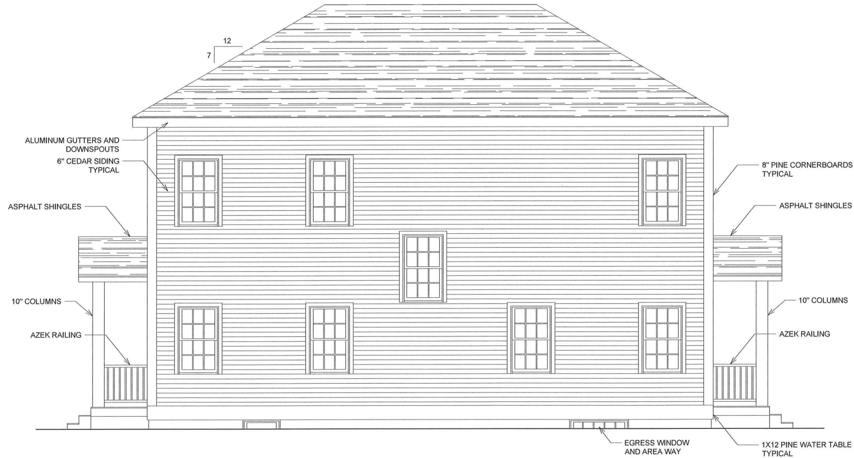
RIGHT ELEVATION SCALE: 1/4" = 1'-0"
